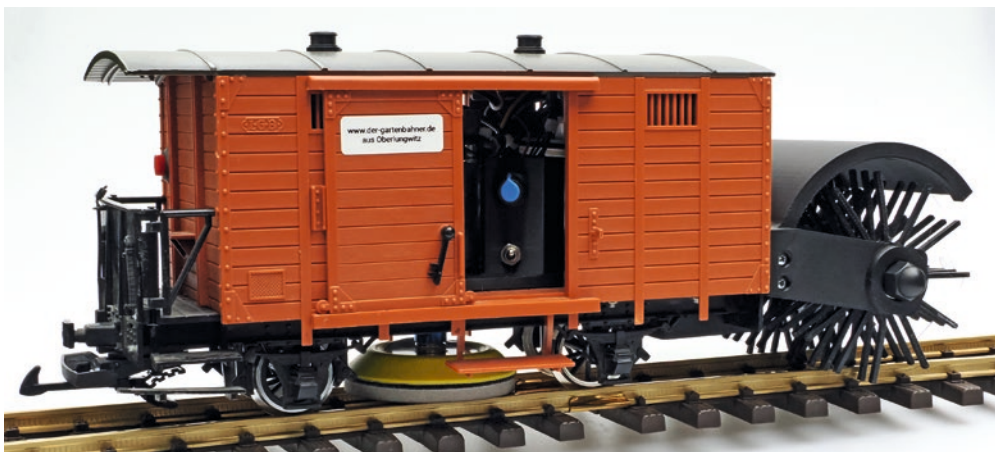
Die Schleifeinheit findet Platz in einem LGB-Wagen der 4030-Serie, hier mit Metallachsen ausgerüstet. Die Bedienung erfolgt bei geöffneten Türen durch beidseitig angebrachte Potis (links für die Schleifeinheit, rechts für die Reinigungsbürste). Das leihweise zur Verfügung gestellte Testmodell war zusätzlich mit einem Scheinwerfer und der Reinigungsbürste ausgestattet.
