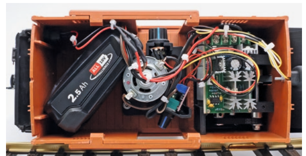
Das Innenleben des zum Reinigungsfahrzeug ausgerüsteten LGB 4030: Links ist der Bosch-Akku 18 V (grüne Werkzeugserie) mit dem gedruckten Stecker zu sehen, mittig der senkrecht stehende Motor für den Schleifteller und rechts im Bild (am Modell vorne) ist die Elektronik verbaut. Darunter steckt, hier nicht sichtbar, die Motor-/Getriebeeinheit für die Bürste.
