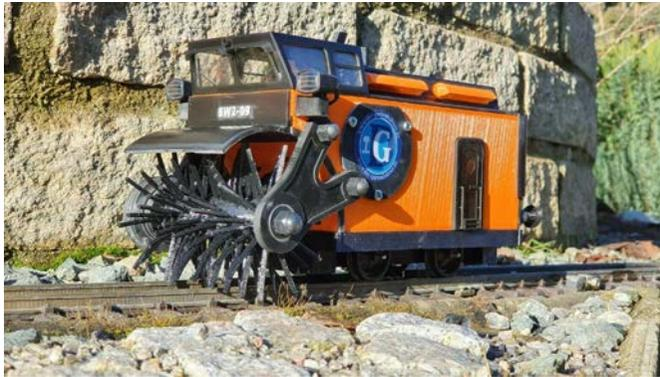
Er ist klein und schlank und die vorgelagerte Bürste befindet sich direkt am Wagenkasten. Dies hat den Vorteil, dass er besser in Kurven mit Radius 1 agieren kann. Der Strom für die Bürste kann über die Schiene oder über einen internen Akku aufgenommen werden.
