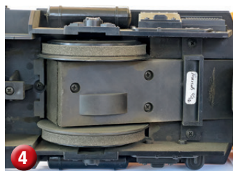
Die Schleifräder der LGB-Lok stehen senkrecht auf den Schienenköpfen und können in der digitalen Ausführung des Modells separat geschaltet werden.
