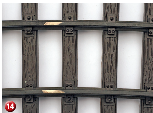
Beim Putzteufel lag die Reinigungseinheit nicht exakt parallel zur Gleisoberkante, wie hier nach 5 Minuten Schleifen im Stand zu erkennen ist. Eine Unterlegscheibe oder ein dickeres Vlies schaffen leicht Abhilfe.
