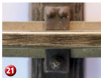
Schienenprofile unter der Lupe: links neuwertiges LGB-Gleis, sowie Profile nach Reinigung durch Schleifhexe von Modellbahn Elmshorn, Reinigungslok von LGB und Putzteufel von Der Gartenbahner.
