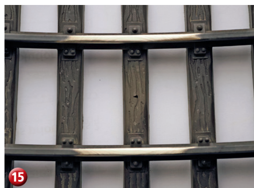
Schleifhexe von Modellbahn Elmsborn: Eine Minute drehte sich das Schleifpad im stehenden Wagen, dann waren die darunter liegenden Schienenprofile vollkommen blank poliert.
