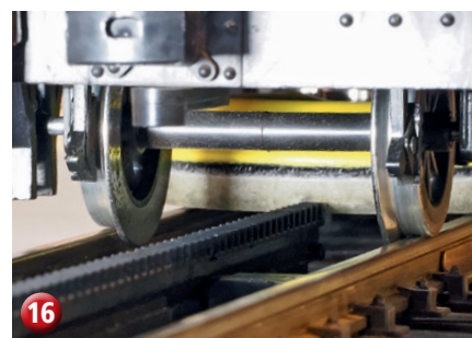
Zahnstangenabschnitte sind von den Schleifteller-Wagen nicht befahrbar. Auch andere hochstehende Einbauteile werden vom Schleifpad erfasst und „bearbeitet“.
